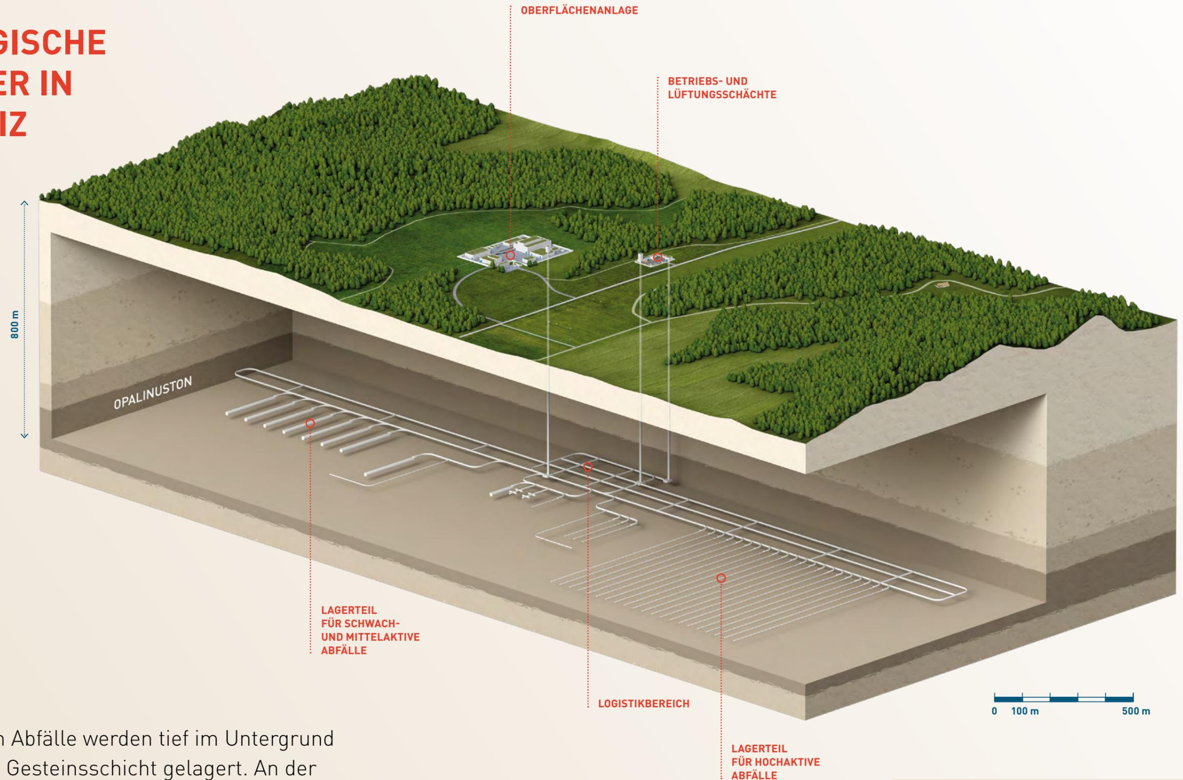
Die radioaktiven Abfälle werden tief im Untergrund in einer dichten Gesteinsschicht gelagert. An der Oberfläche gibt es Anlagen für Bau und Betrieb. Schächte verbinden die Oberflächenanlagen und das Lager in der Tiefe.
